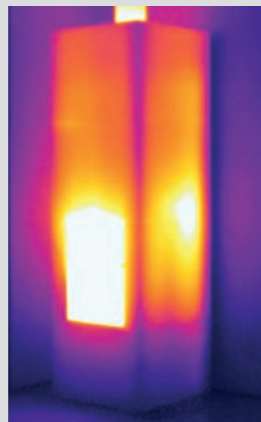
3 órával a befűtés után az átlagos felületi hőmérséklet 88 °C
