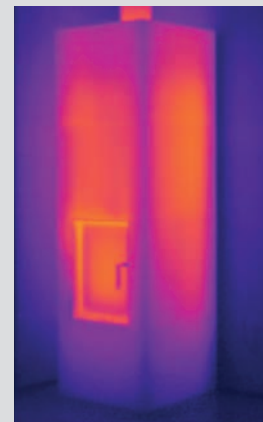
12 órával a befűtés után az átlagos felületi hőmérséklet 45 °C
